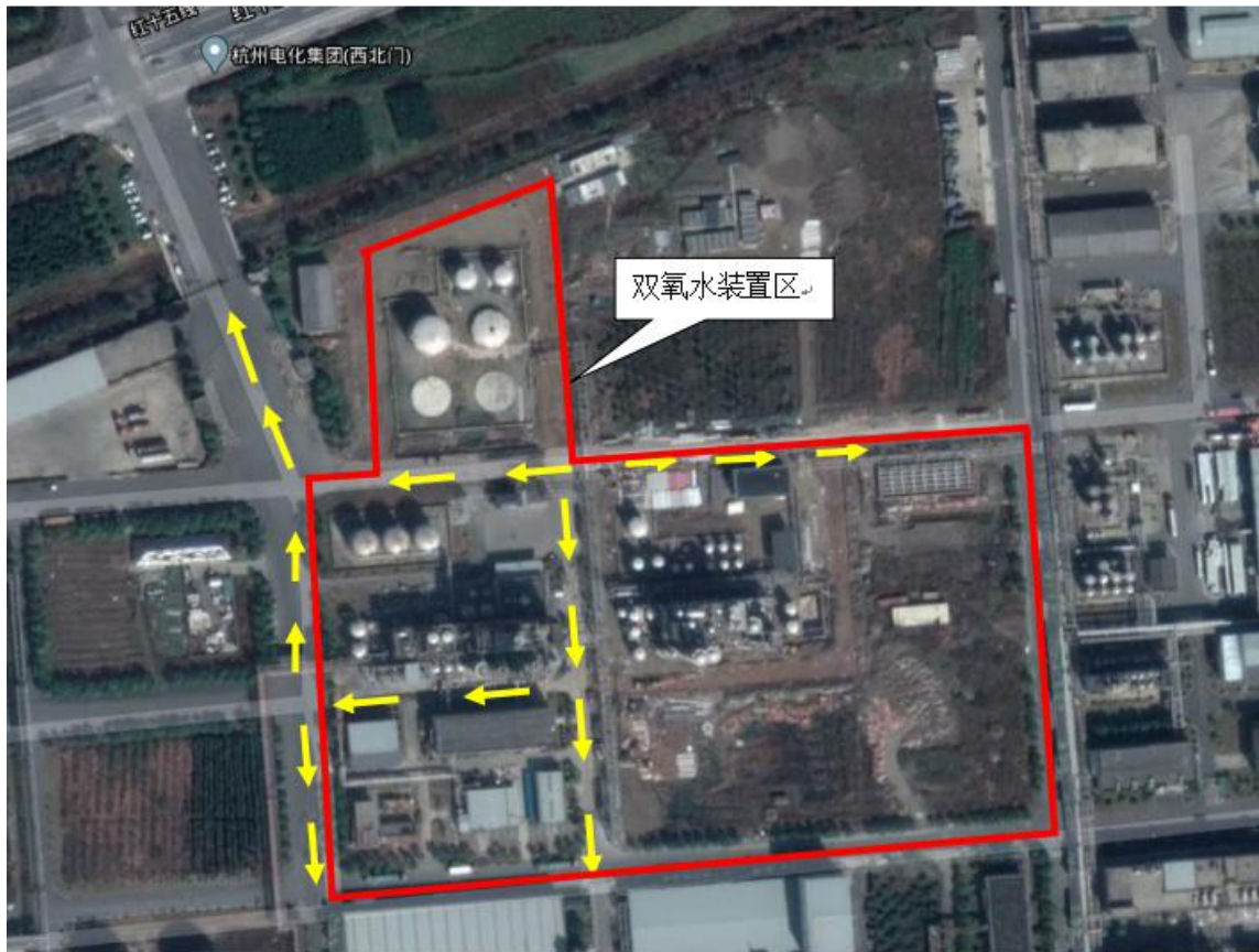
图 8-5 厂内应急疏散路线图
