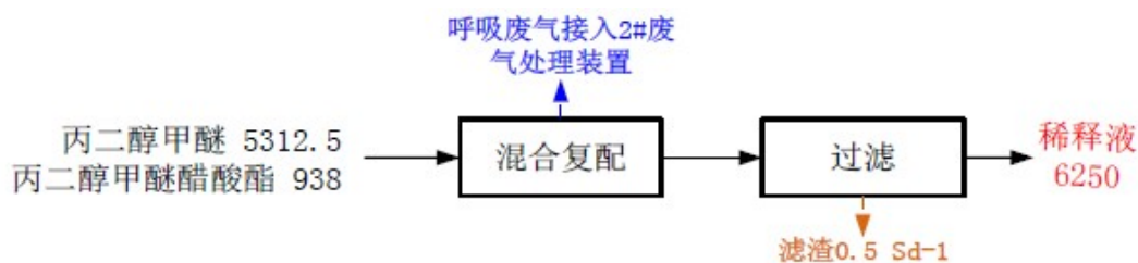
图 2.2-35 稀释液工艺流程及产污位置图 单位：kg/批
