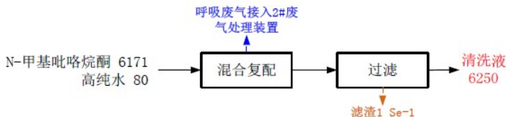
图 2.2-36 清洗液工艺流程及产污位置图 单位：kg/批
